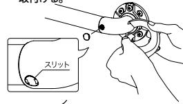
※ねじキャップには方向性があるため、スリットは左図の向きで取付ける。
